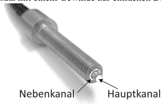
Abbildung 3: Tastkopf mit koaxialer Faseranordnung
