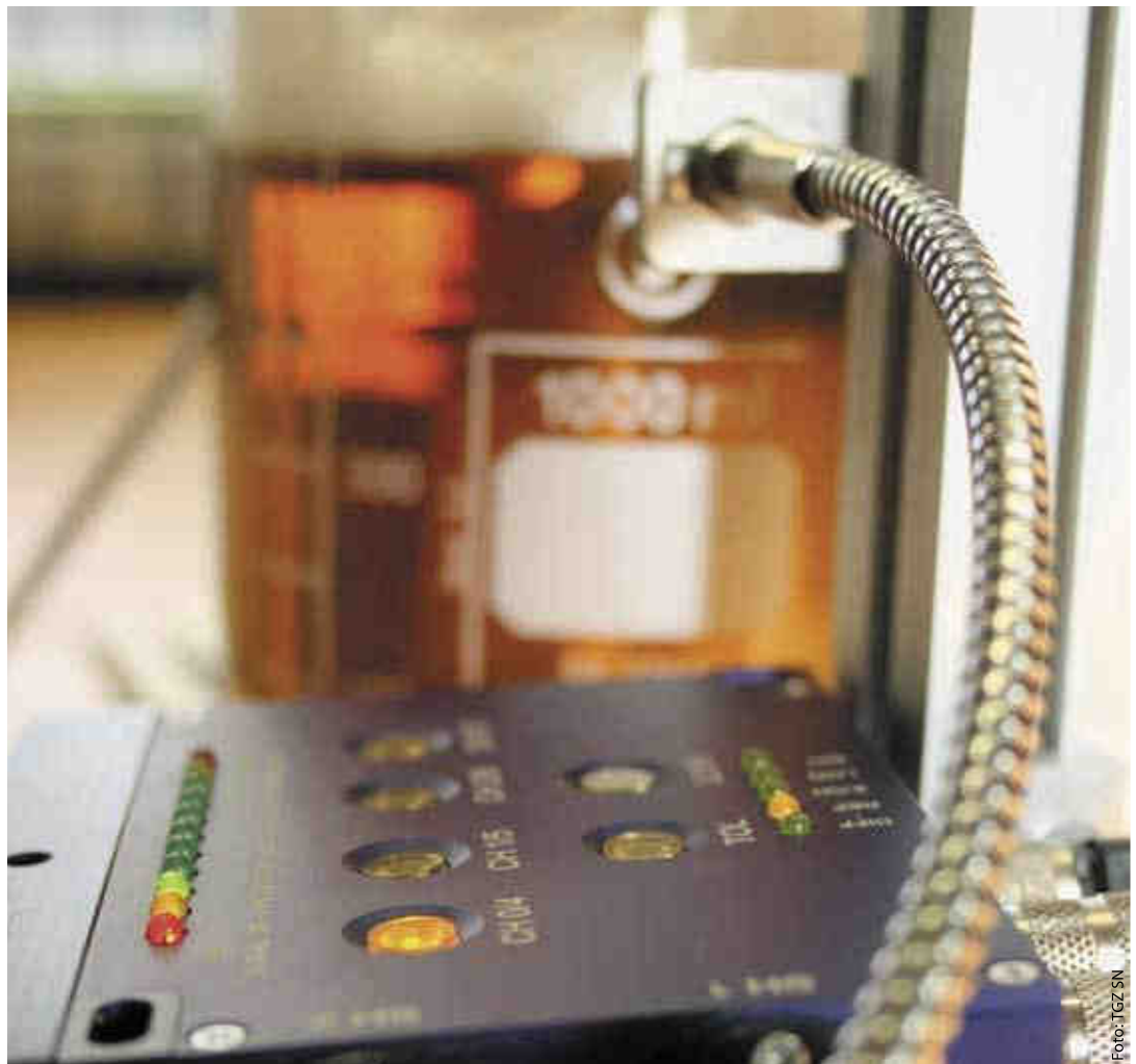
Labor-Messung der EBC-Farben von Bier
