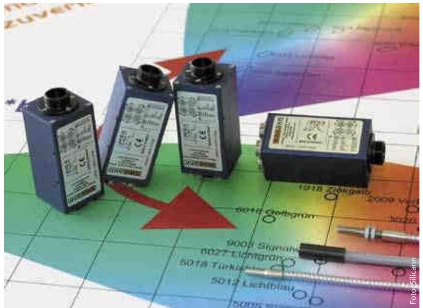
Die perzeptiven Farbsensoren der PCS-Familie entsprechen in ihrer spektralen Farbempfindlichkeit dem menschlichen Farbempfinden.
