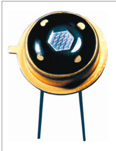
Bild 8. Der „MTCSi TrueColor“-Sensor mit Normspektralwertfunktion.
