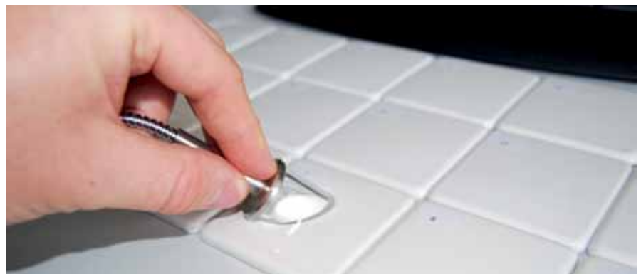
Bild 2. Die Emaillieabdeckungen werden mit einem Farbsensor mittels Lichtleiter im Winkel von 45^\circ farblich vermessen, damit der Glanz bei der Messung ausgeschlossen ist.
